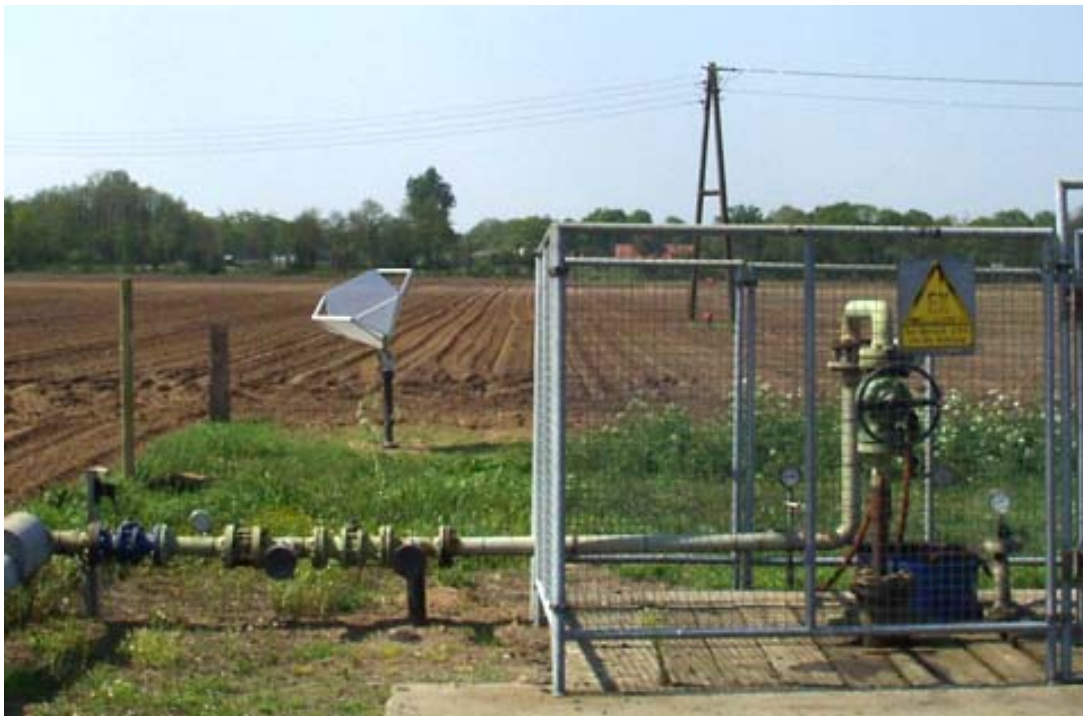
Abb.2 : Corner Reflektor (links im Bild) neben einer Erdölförderanlage
