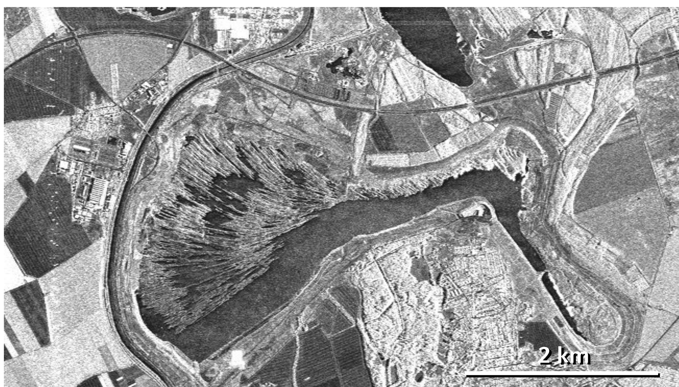
Abb. 2: Radar-Intensitätsbild eines sich in Flutung befindlichen Tagebaus, aufgenommen von TerraSAR-X (verkleinert, originale Bodenauflösung ca. 2 m/Pixel)
